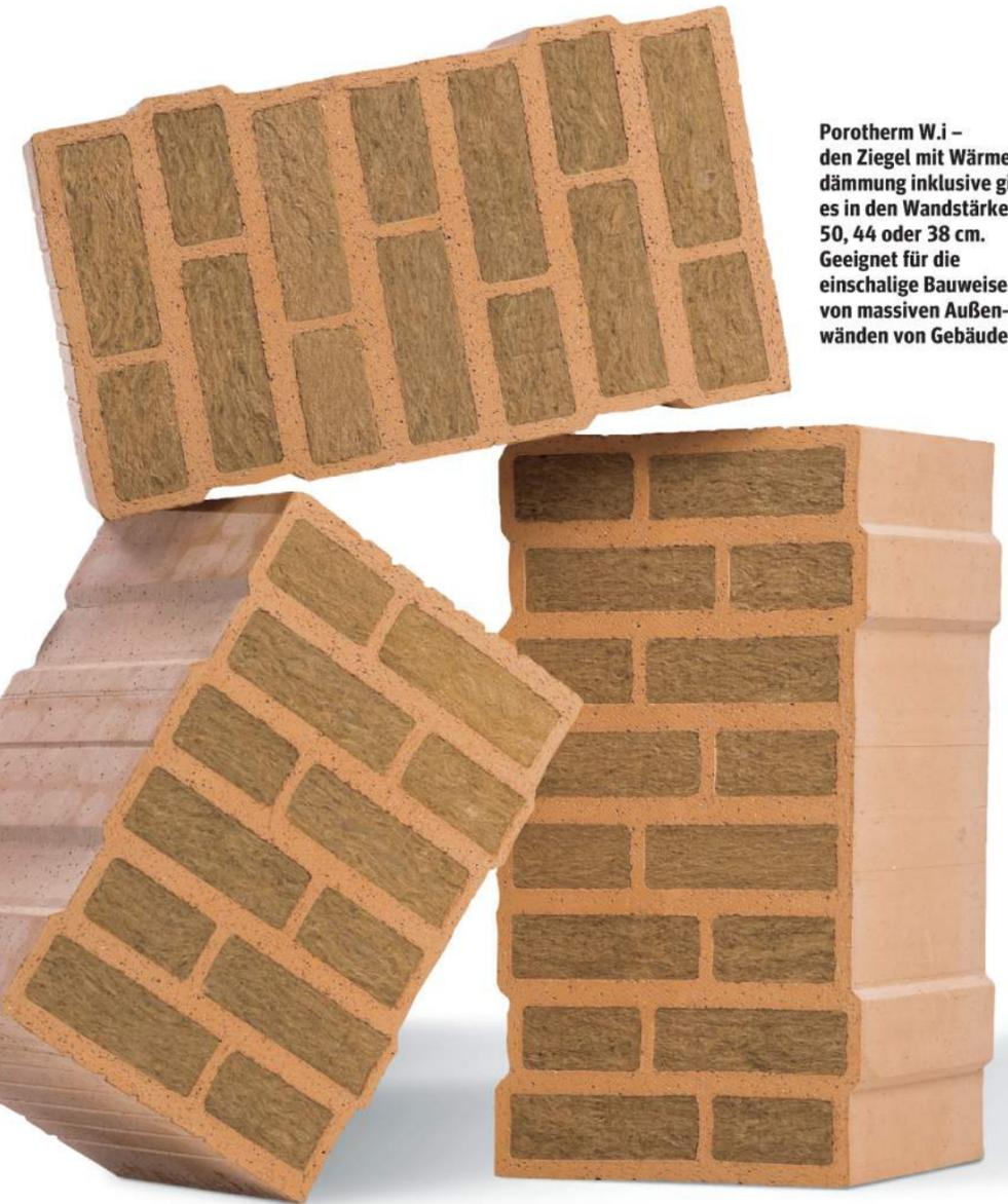
**Porotherm W.i – den Ziegel mit Wärmedämmung inklusive gibt es in den Wandstärken 50, 44 oder 38 cm. Geeignet für die einschalige Bauweise von massiven Außenwänden von Gebäuden**
